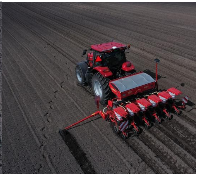
真空播種機による播種作業
