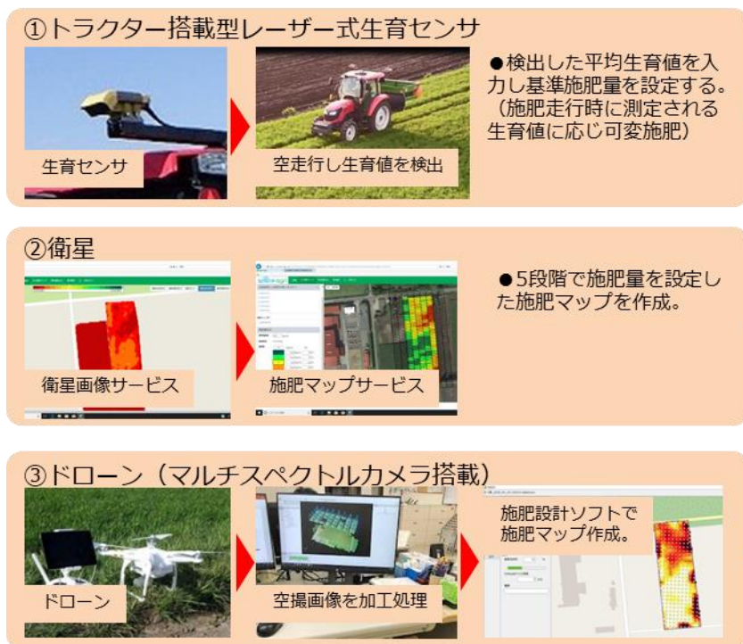
試験に使用したリモートセンシングと可変施肥の機器類 (アグリポート 18 号より抜粋)
